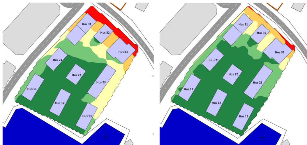
Bild, Buller från vägtrafik vid uteplats. Beräkningshöjd ovan mark: 1,5 meter. Ej frifältsvärde, prognosår 2035. Vänster bild ekvivalent ljudnivå, höger bild maximal ljudnivå.
